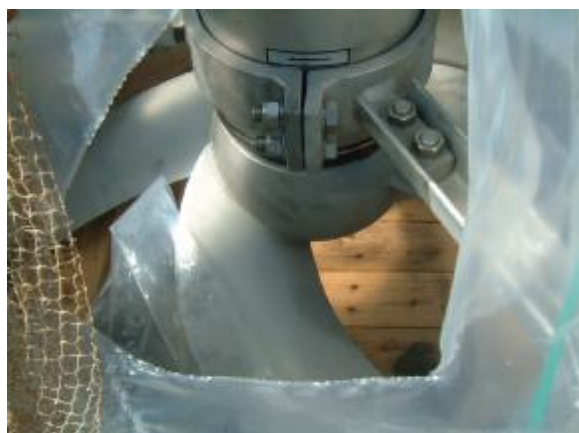
Fig. 8.3.1 Impianto di Fibbia. Parte mobile della nuova idrovora prima della sua installazione
