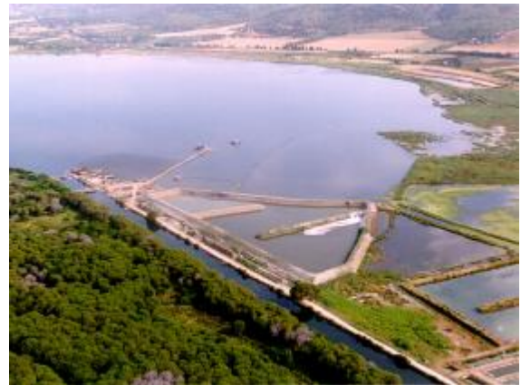
Fig. 11.4 La zona conterminata restituita alla Laguna dopo il dragaggio con diversa qualità delle acque e con la piazzola per l'attracco dei battelli raccogli alghe; in primo piano la nuova cassa di colmata.
